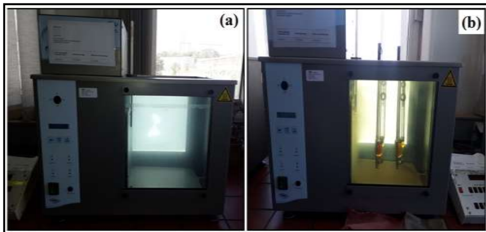
Figure II. 13: Viscosimètres utilisés ; (a) : à 40°C ; (b) : à 100°C
