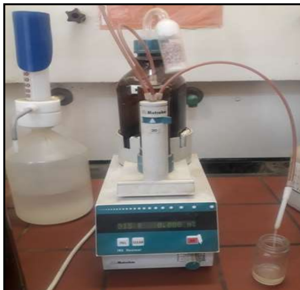
Figure II. 14: Détermination de la teneur en zinc par titrage
