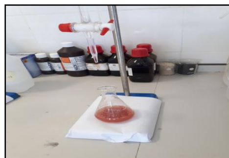
Figure III. 20: Après le dosage de Chlorure
