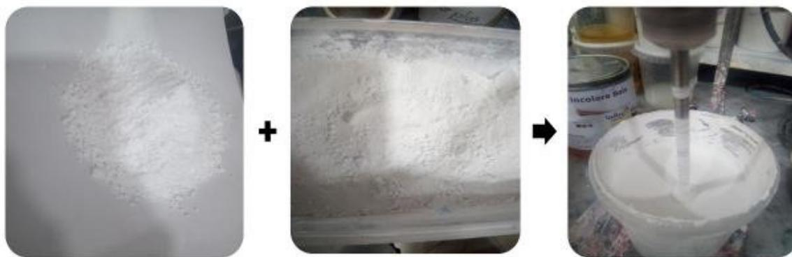
Figure III. 12: Mouillage des matières pulvérisées.
