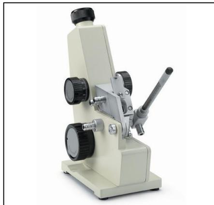
**Figure III. 5:** Réfractomètre.
