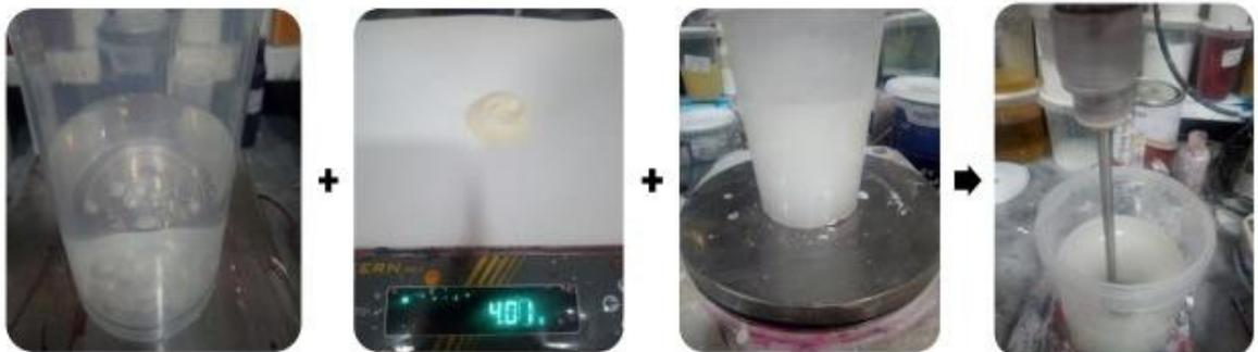
**Figure III. 11:** Préparation et agitation du mélange (eau + additifs).
