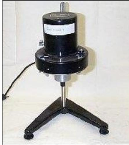
**Figure III. 2:** Viscosimètre Brookfield.
