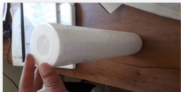
Figure III.6 : Filtre à cartouche avant le procédé de traitement.
