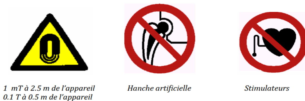
FIGURE 3.5 – Pancartes de signalisation du risque des ondes électromagnétiques
