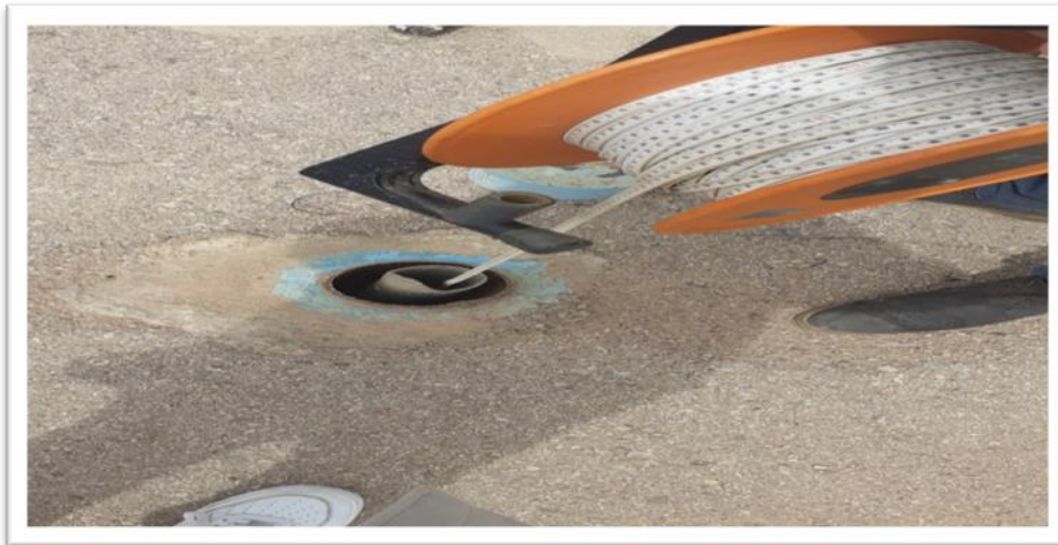
Figure III.6 : Méthode de lecture de piézomètre (16/03/22)
