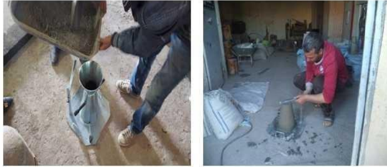
Figure III.6. Affaissement au cône d'Abrahams
