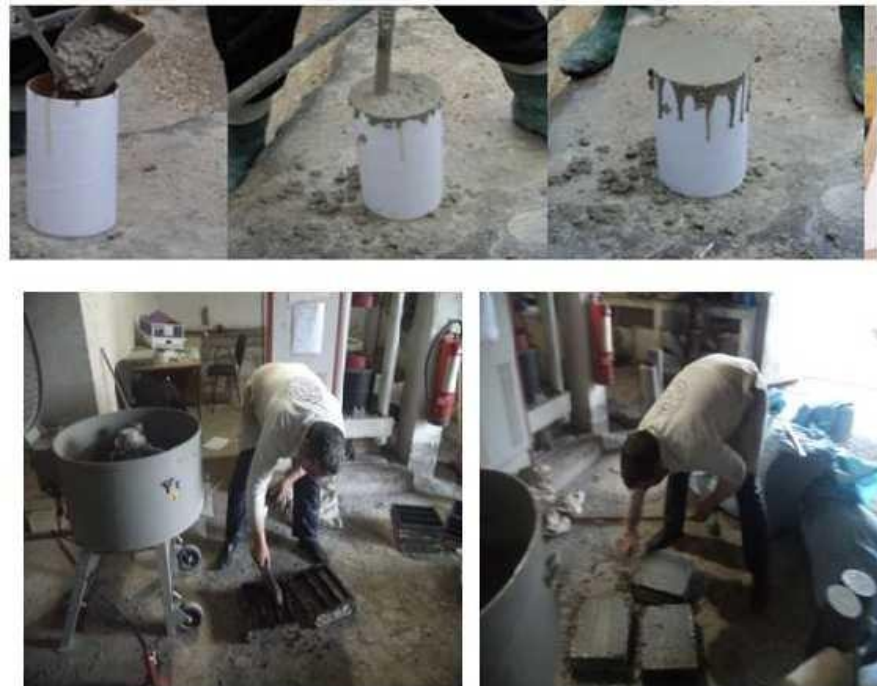
Figure III.5 - Confection des éprouvettes (cylindriques et prismatiques)
