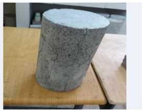
Exemple de mode de rupture
