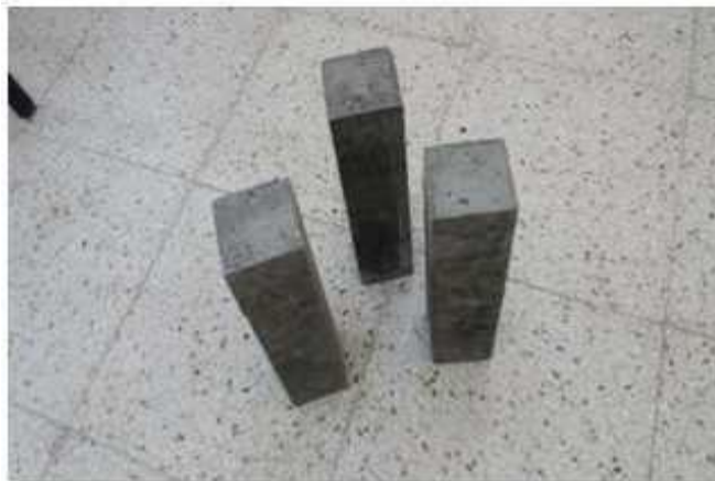
Éprouvettes prismatiques 7x7x28 cm
