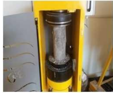
Éprouvette après écrasement
