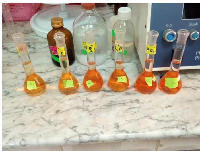
Figure III.4 : Solutions de mesure de la teneur en aluminium pour les différentes eaux traitées.
