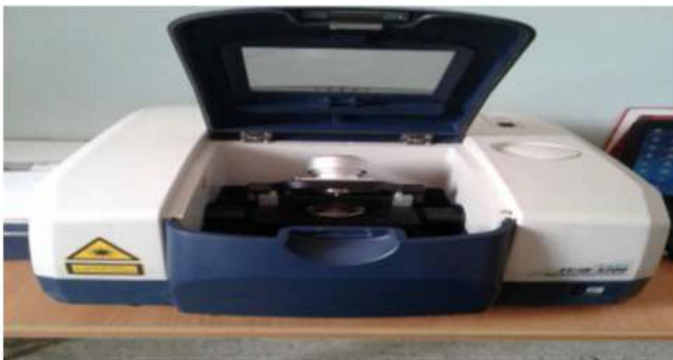
**Figure.III.23.** Spectroscopie Infrarouge à Transformée de Fourier (FTIR).
