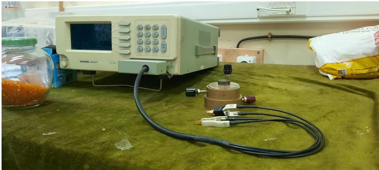
Figure III.25. Photo du LCR mètre.
