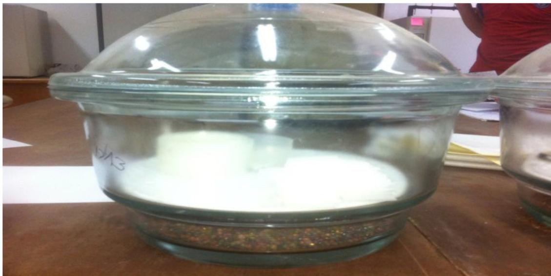
**Figure III.21.** Schéma d'un échantillon placé dans dessiccateur.
