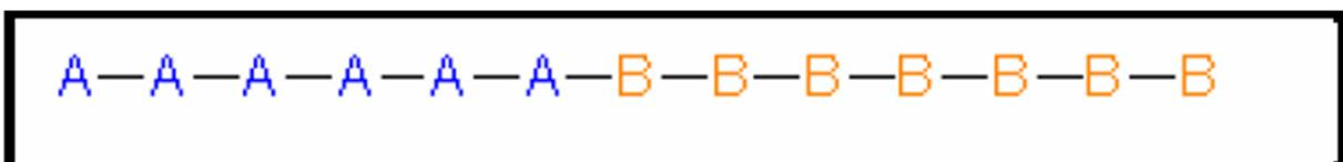
Figure. I.4. Structure moléculaire d'un copolymère séquencé.
