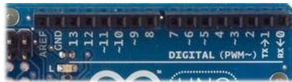
Figure II.2 : Les 14 entrées sorties numériques.
