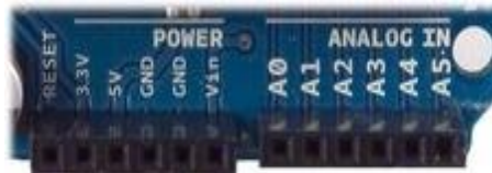
Figure II.3 : Les 6 entrées sorties analogiques.
