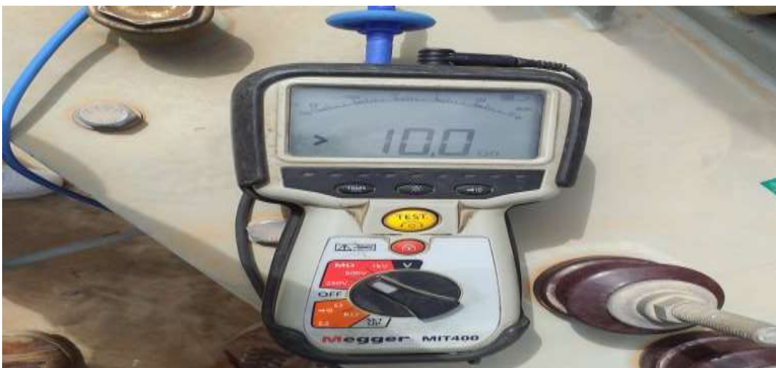
Figure III.19. Résultat de mesure d'isolement cas d'absence de défaut
