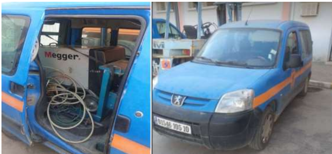
Figure III.2. Véhicule laboratoire de recherche défaut
