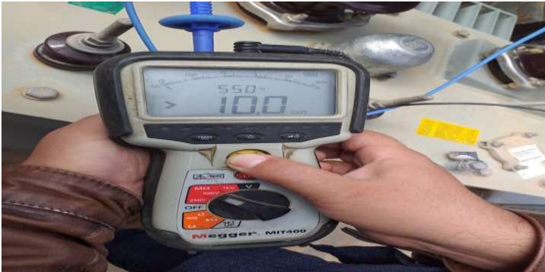
Figure III.18. Résultat de la mesure de continuité (cas de défaut)
