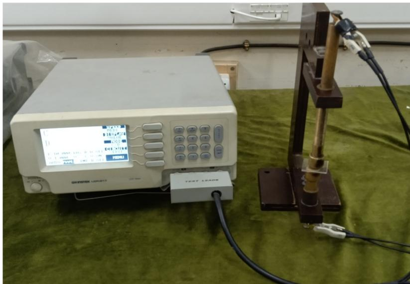
Figure III.1. Impédance-mètre de type Gw Instek LCR-817.
