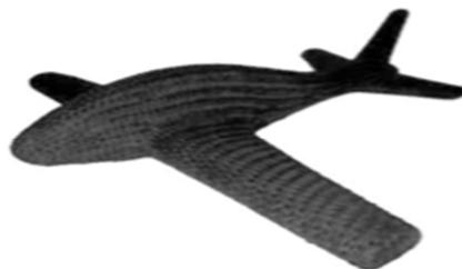
**Figure II.10.** Un modèle réduit d'avion en tissu de carbone 3D, réalisé pour tester un procédé de fabrication de préformes (image de l'Université nationale du design et des technologies de Moscou) [15]
