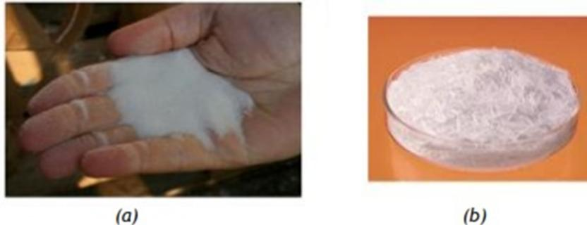
**Figure II.8. (a)** Particules (microbilles) de verre ; **(b)** fibres de verre courtes [15].
