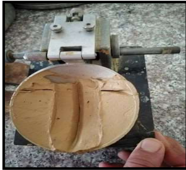
Figure 25 : Réalisation d'une rainure centrale.
