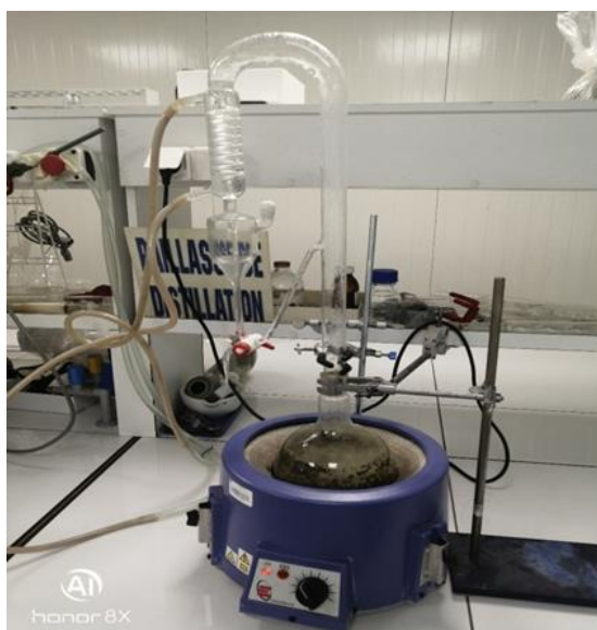
Figure II.2 : Appareil de Clevenger pour l'extraction des huiles essentielles [Originale].
