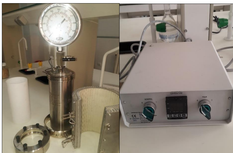
Figure IV.4 : Réacteur hydrothermal utilisé
