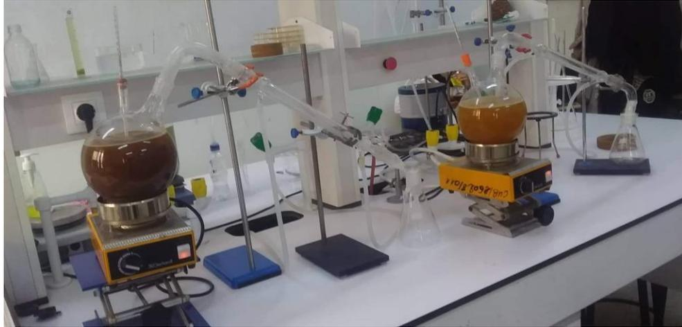
*Figure IV.4: Photo du dispositif de la distillation alcoolique*
