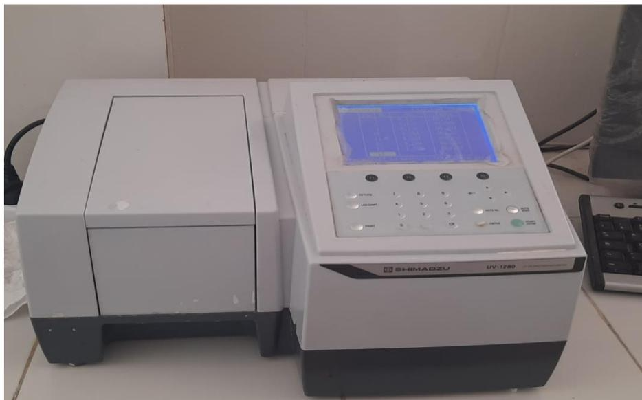
**Figure II.4 :** Spectrophotomètre (SHIMADZU UV-1280).
