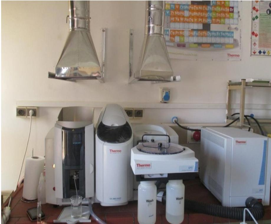
**Figure II-2:** Spectrophotomètre d'adsorption atomique Thermo Scientific ; ICE 3000 Serie.
