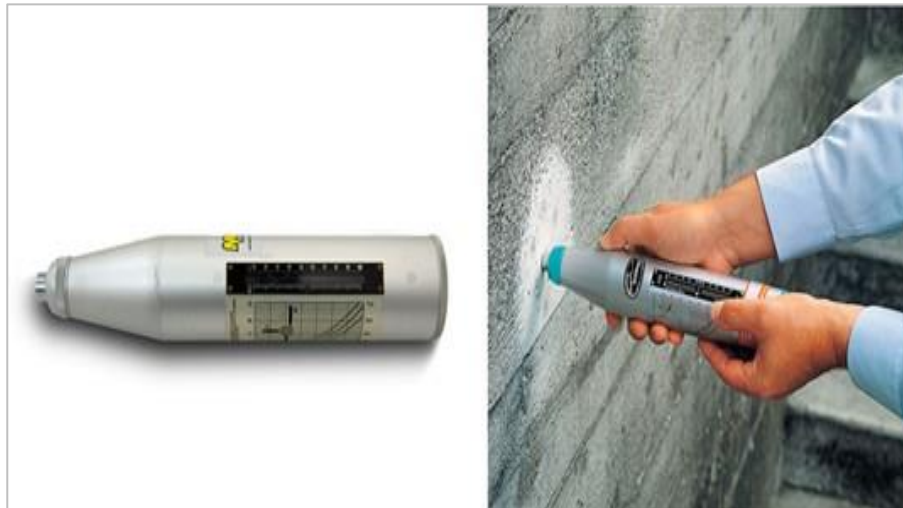
Figure II.4: Méthode no destructive (Scléromètre)
