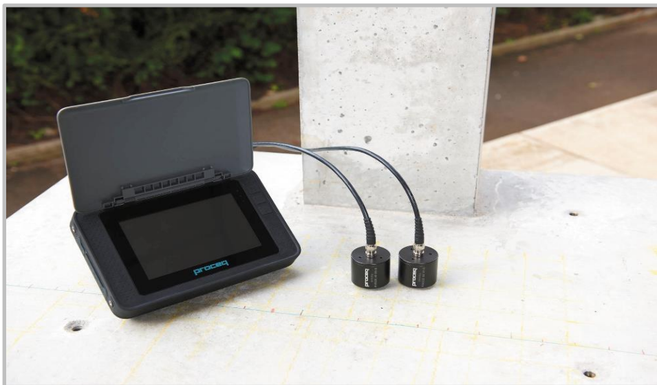
Figure III.1 : appareil de mesure (Pundit PL 200)
