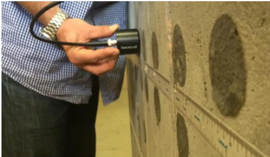
Figure III.5 : Mesures ultrasons d'un bloc béton avec les transducteurs plats 54 kHz (avec gel couplant) [18]
