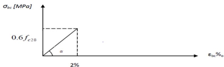
Figure I.2 : Diagramme contraintes déformations du béton à l'ELS.
