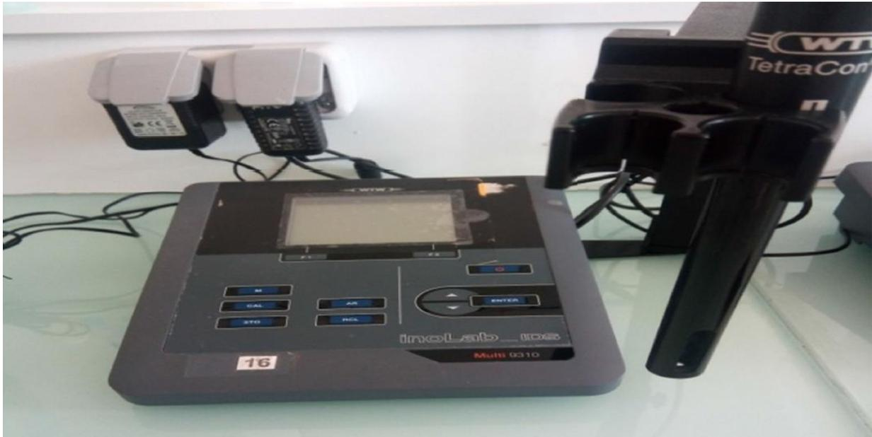
*Figure 0-4: Conductimètre de paillasse Cond 3151, WTW.*
