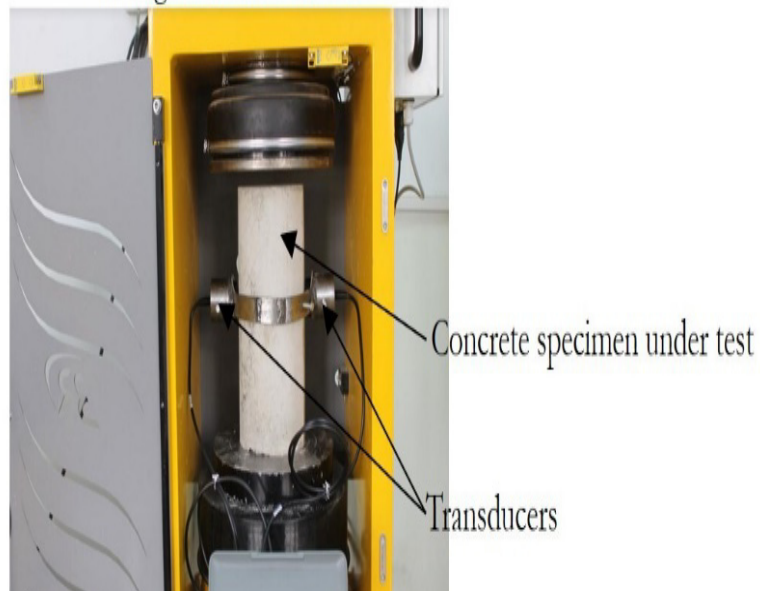
Figure [4.5] - Ultrasonique NDT durant la compression des éprouvettes de béton.
