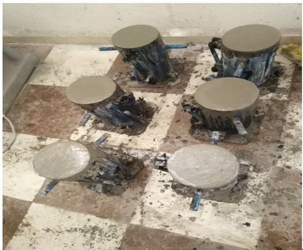
Figure [3.10] (1.2.3.4) - préparation des éprouvettes
