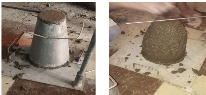
Figure [3.9] - l'affaissement de notre béton.
