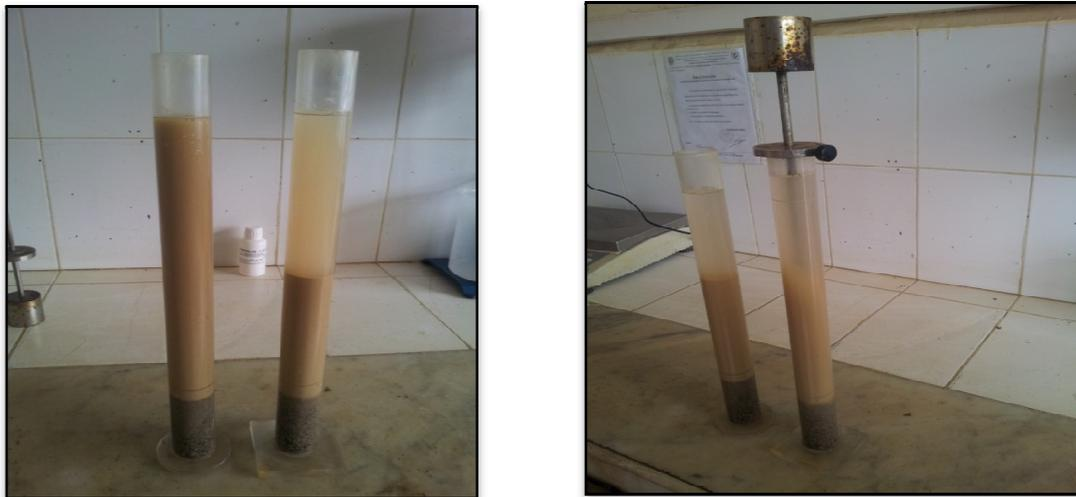
**Figure III.1.** L'essai d'équivalent de sable.
