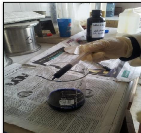
**Figure III.2.** L'essai de bleu méthylène.
