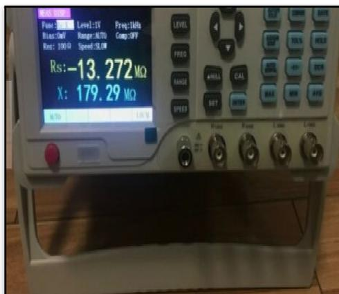
Figure III.29. Appareil LCRmètre
