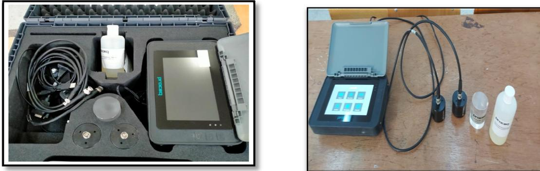
Figure III.17. Appareil de test ultrasonique Pundit-Lab.
