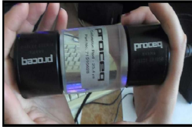
**Figure III.19.** Remise à zéro du Pundit Lab avec la barre de calibration.
