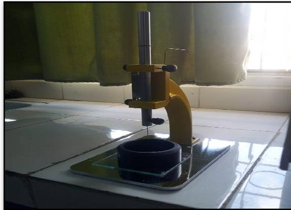
**Figure III.6.** Appareil de Vicat.
