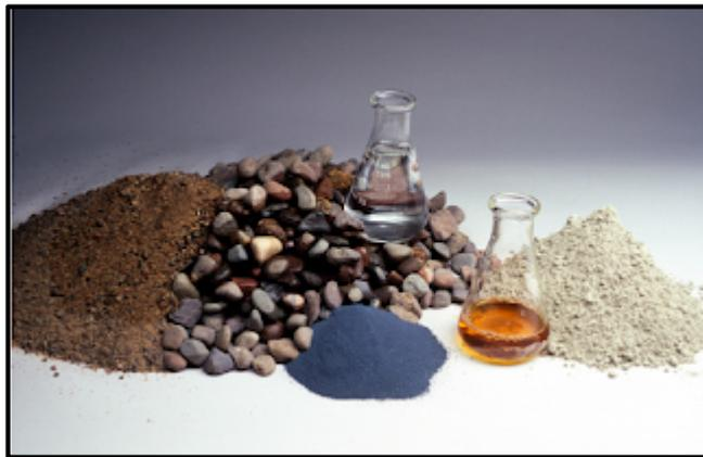
Figure I.13. Les composants d'un béton.
