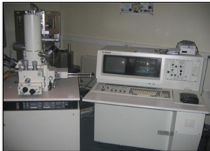
**Figure III.32.** Microscope électronique à balayage.
