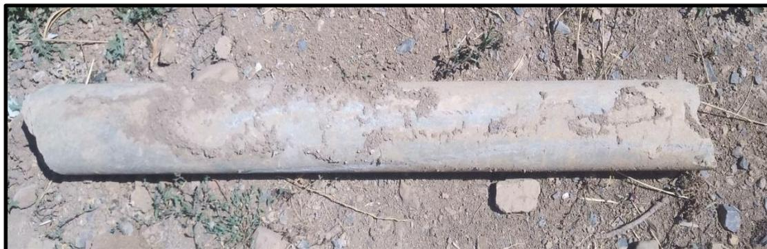
**Figure III.1: Conduite en amiante ciment**
