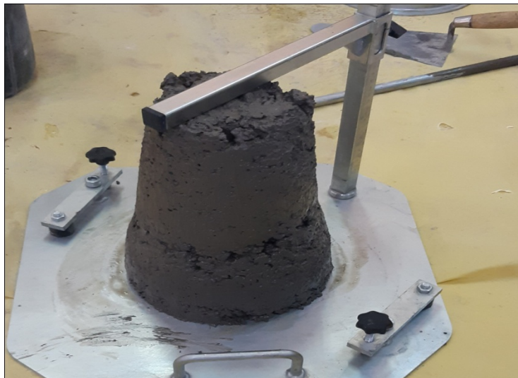
Figure III. 6. Essai d'affaissement du béton ordinaire lourd.
