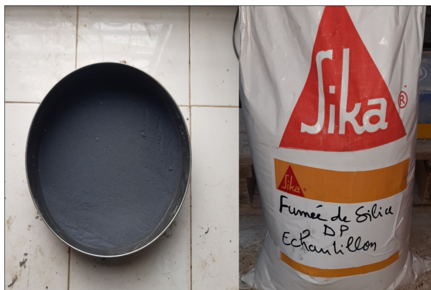
Figure III. 4. La fumée de silice Condensil S-95 DP SIKA.
