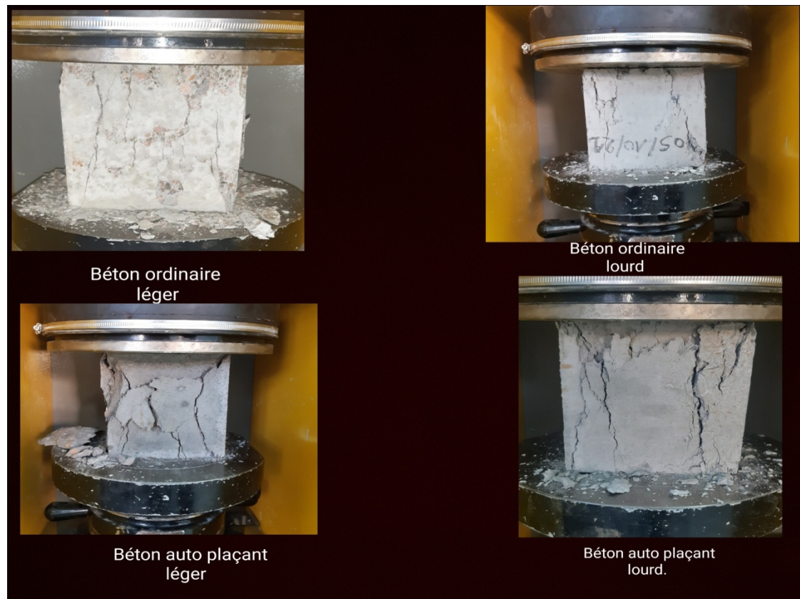
Figure III. 16. mode de rupture du béton, éprouvette (15x15) cm 3 .
