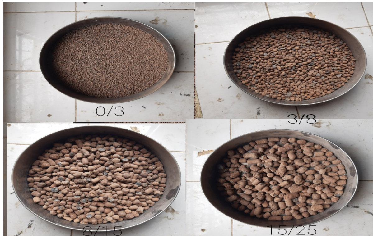
Figure III. 2. Les granulats légers utilisés (l'argile expansée).
