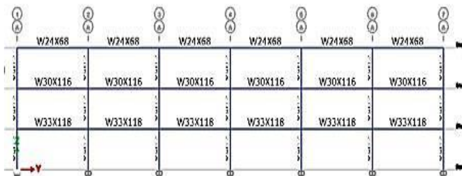
Figure III.1: vue en élévation des 3 étages.
