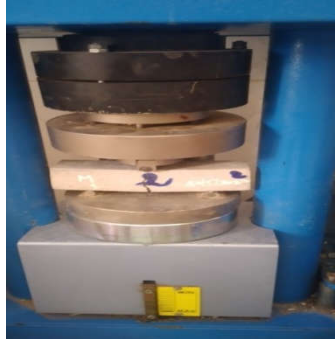
Figure IV.45. Essai de la résistance mécanique à la flexion trois points après 28 jours.
