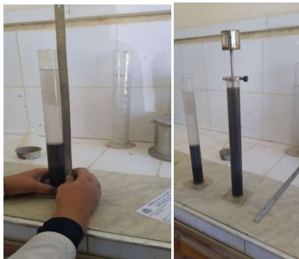
Figure III.30. Essai d'équivalent de sable visuel et par piston.
