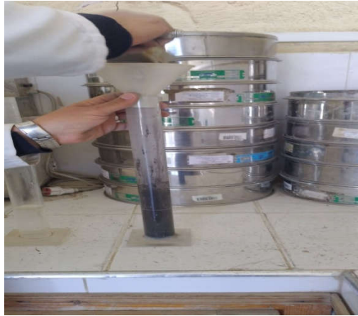
Figure III.29. Détermination de l'équivalent de sable.
