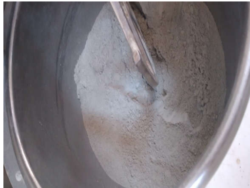
Figure III.37. Malaxage des constituants de mortier cellulaire.
