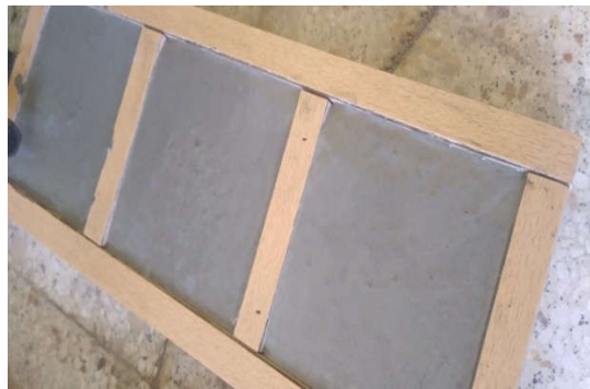
Figure III.39. Éprouvette (10x10x2) pour les essais thermique.
