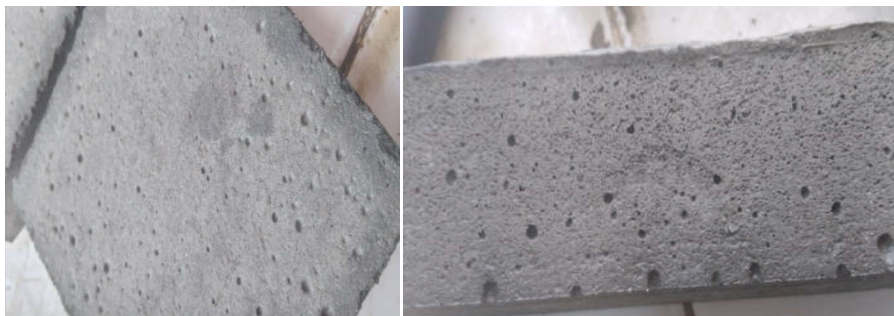
Figure IV.42. Les vides sur les surfaces de l'éprouvette.
