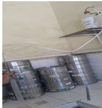
Figure III.28. Essai d'équivalent de sable.
