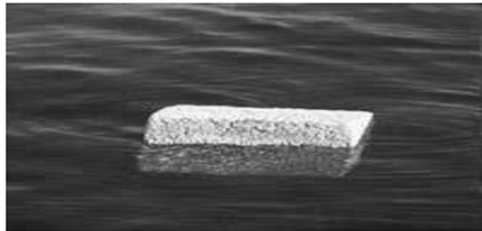
Figure II. 23. Légèreté d'un béton cellulaire [9].
