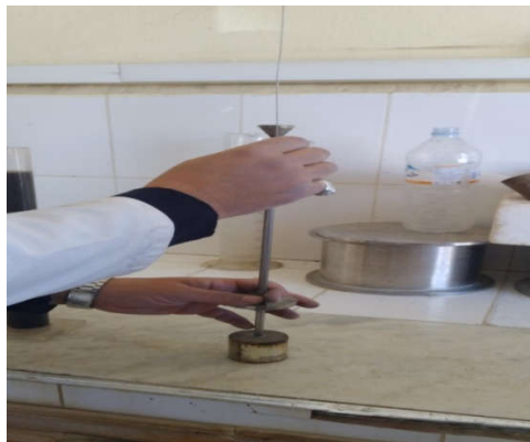
Figure III.31. Détermination de l'équivalent de sable par piston.
