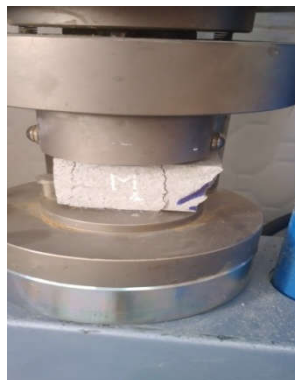
Figure IV.47. L'essai de la résistance mécanique à la compression après 28j.
