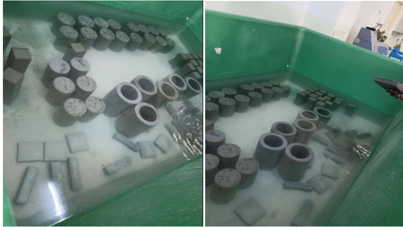
Figure III.40. Mode de conservation des éprouvettes.
