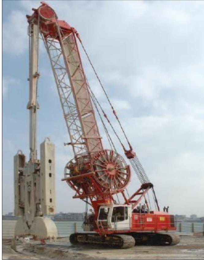
**Figure 1.11 :** Benne hydraulique KS2
