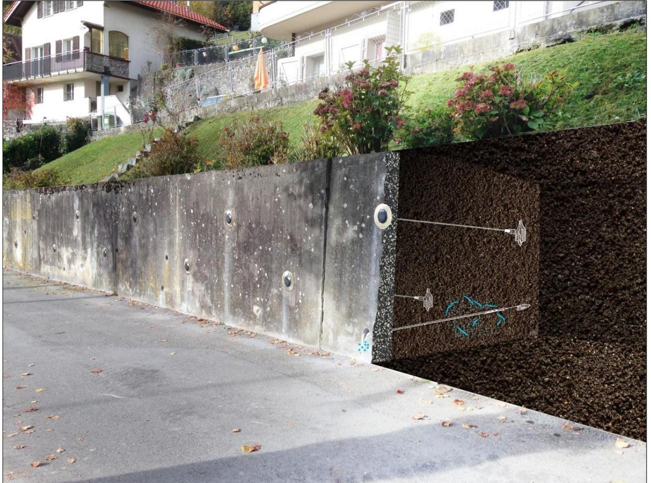
**Figure 1. 17:** Mur en T avec encrage
