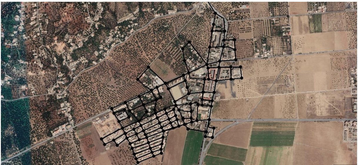
Figure 36: Tracé de réseau d'AEP de Bouaklane.
