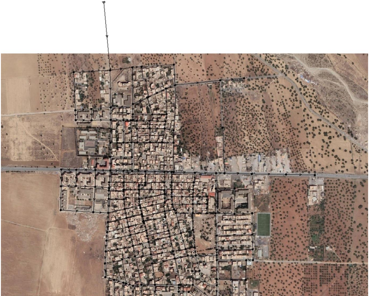
Figure 35: Tracé de réseau d'AEP de raffour.
