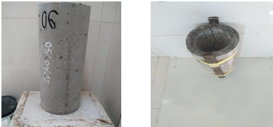
Figure III.9. Epreuve et mode de rupture a)-avant l'écrasement, b)- après écrasement par compression par fendage.
