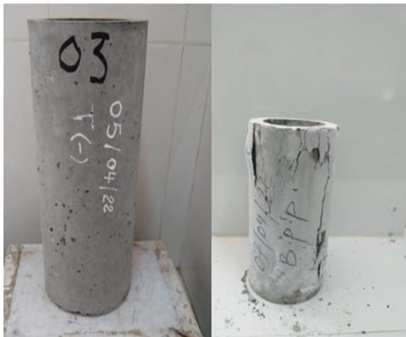
Figure III.11. Eprouvette et mode de rupture a)-avant l'écrasement, b)- après écrasement par compression axiale
