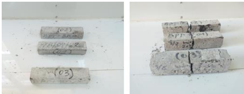
Figure III.7. Eprouvette et mode de rupture a)-avant écrasement, b)- après écrasement par flexion.
