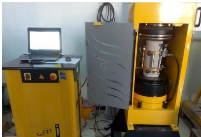
Figure III.1 : Essai de compression : a) machine d'essai de compression b) système LVDT.
