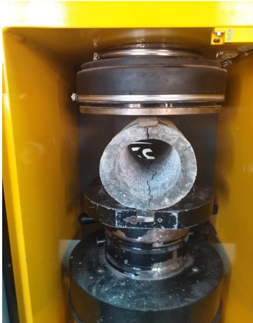
Figure II.18. a) -Essai de traction par flexion des éprouvettes prismatiques 4x4x16 cm, b) essaide compression des éprouvettes 4x4x4 cm , et c) – essai de fendage sr des cylindres de forme tubulaire
