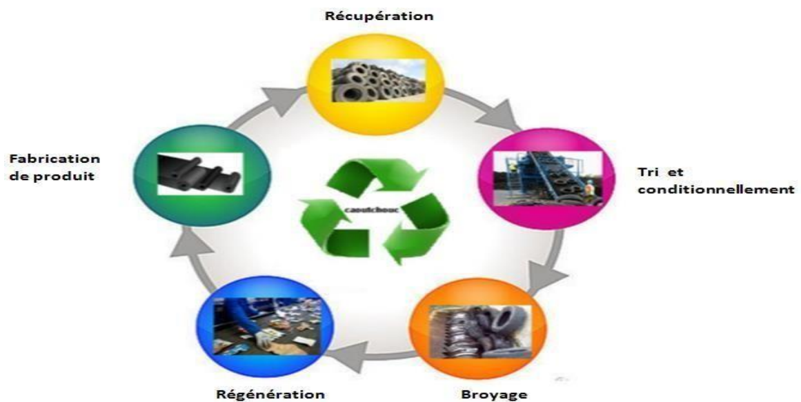
FigureI.7. Processus de recyclage de déchets de caoutchouc [22].
