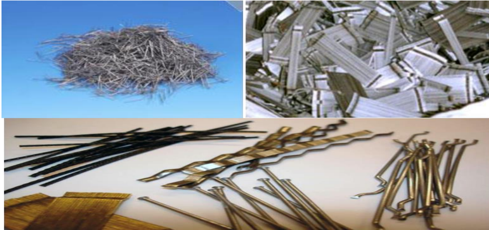
Figure I.4. Les différentes formes de fibres métalliques. [11]
