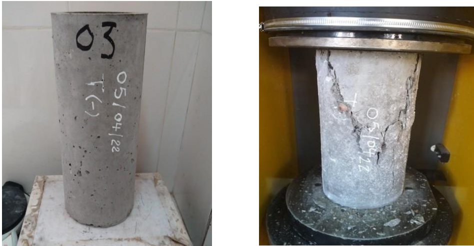
Figure III.5. Eprouvette et mode de rupture a)-avant l'écrasement, b)- après écrasement par compression.
