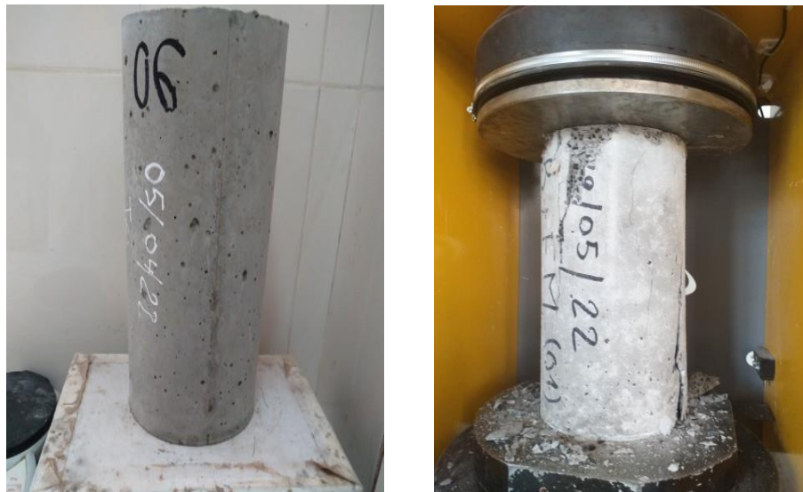
Figure III.16. Echantillon et mode de rupture a)-avant écrasement, b)- après écrasement par compression axiale
