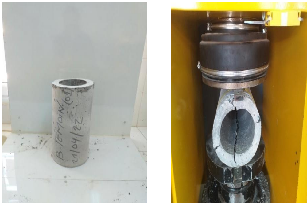
Figure III.14. Epreuve et mode de rupture a)-avant écrasement, b)- après écrasement par fendage
