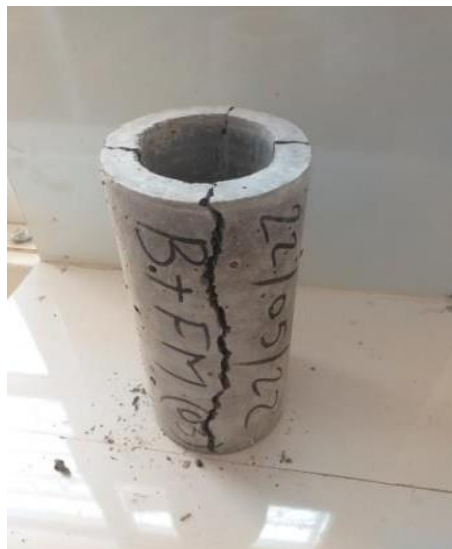
Figure III.18. Mode de rupture du spécimen BFM
