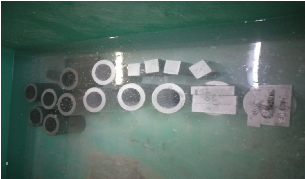
Figure II.13: Conservation des éprouvettes dans une chambre humide.
