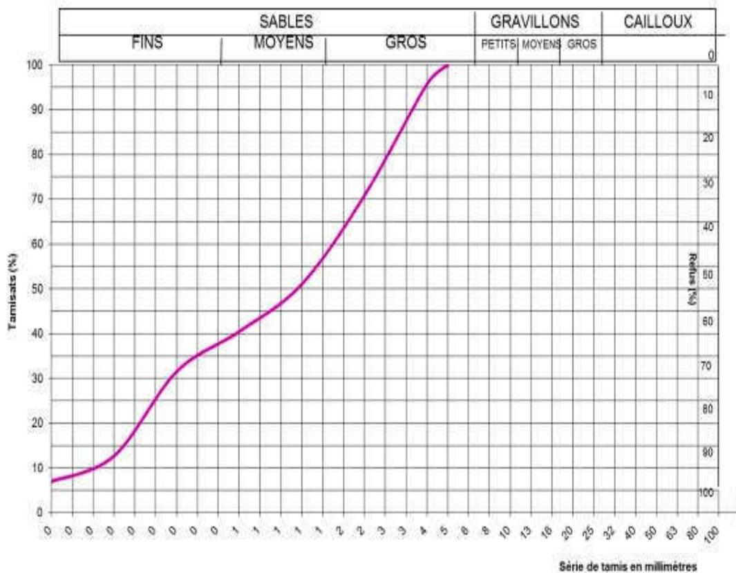
Figure III.3 : Courbe d'analyse granulométrique du sable.
