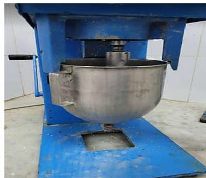
**Figure III.4:Malaxeur de mortier.**
