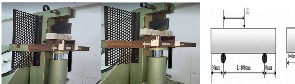
Figure III. 9 : Essai de flexion.
