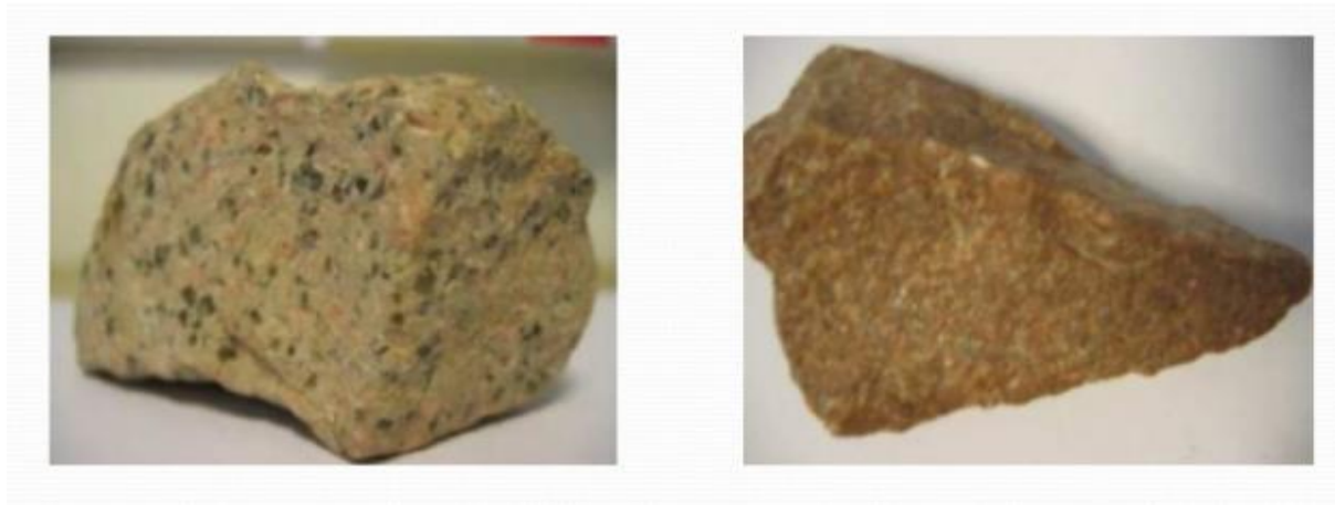
Figure I.4: Différentes formes de ballast
