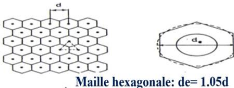
Figure I.28.c : Domaine d'influence de la colonne (maille hexagonale)
