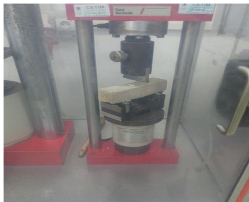
Figure 41 : Dispositif de l'essai de flexion
