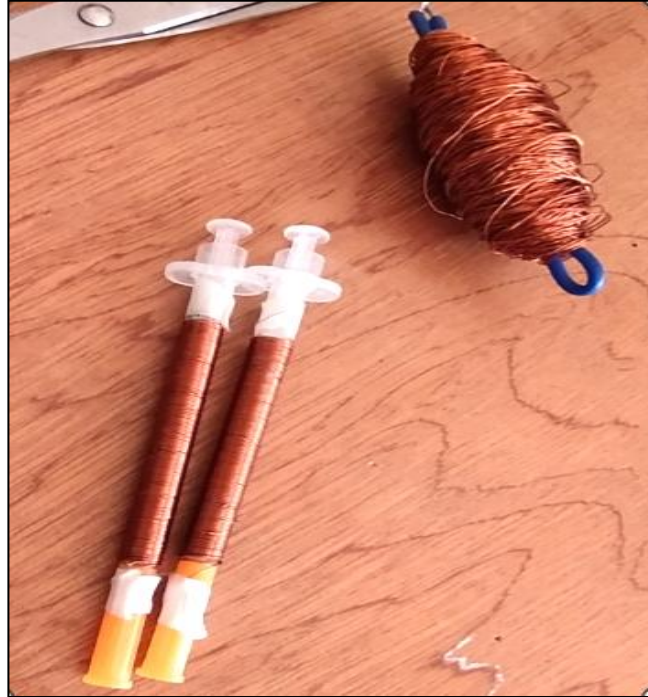
Figure II.12: Préparation d'échantillons pour la mesure de la conductivité électrique.
