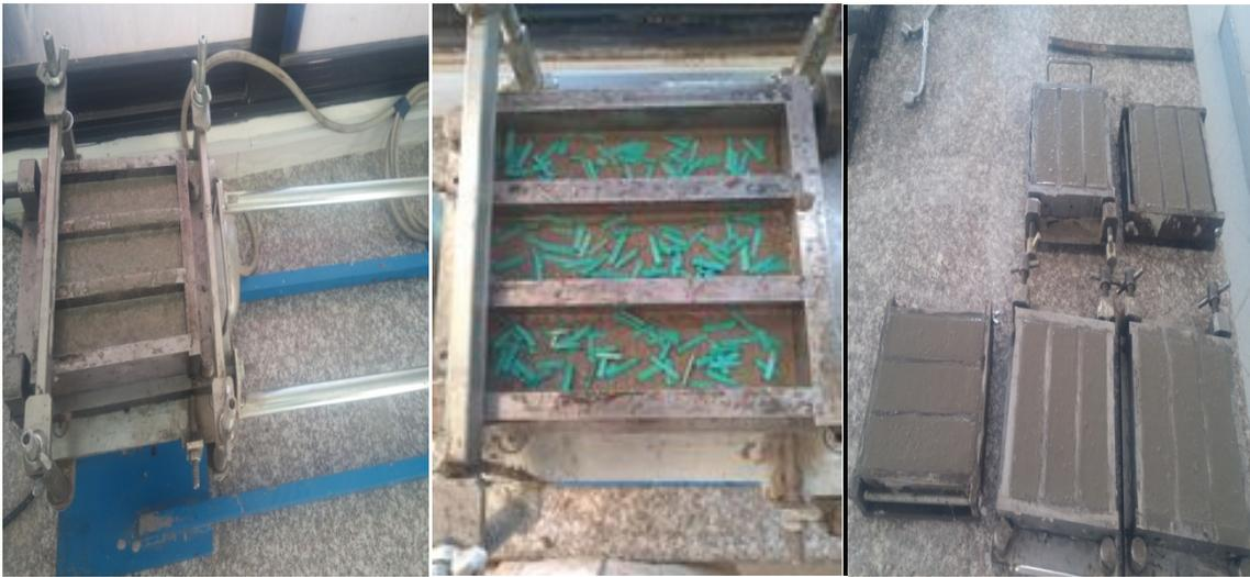
**Figure IV.12.** Confection des mortiers dans les moules.
