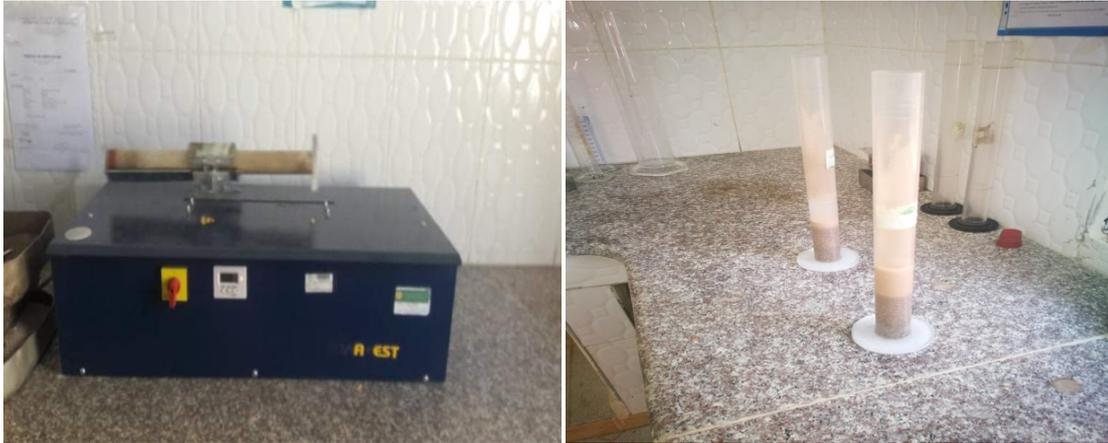
**Figure IV.6.** Essai d'équivalent de sable.
