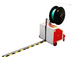
Cercleuse semi-automatique verticale à aiguille TP202MV
