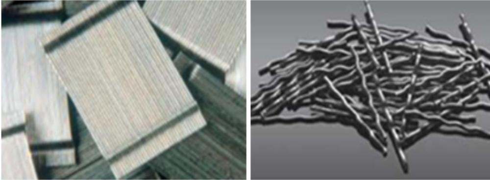
**Figure III.3 :**Fibres métalliques.
