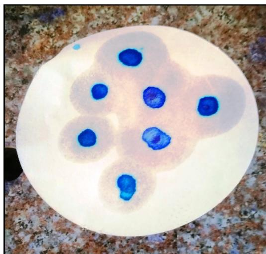
**Figure V.2.** Test à la tache du bleu de méthylène.
