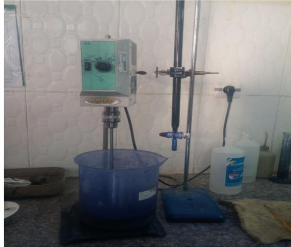
**Figure IV.7.** Appareil de bleu de méthylène.
