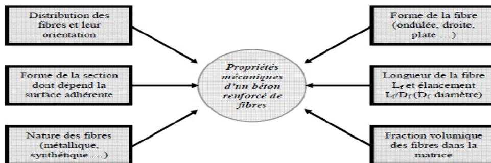
**Figure III.9:** Différents facteurs influant sur le comportement mécanique d'un béton renforcé de fibre.
