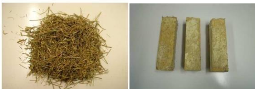
Figure 20 granulats d'alfa après broyage et Béton d'Alfa
