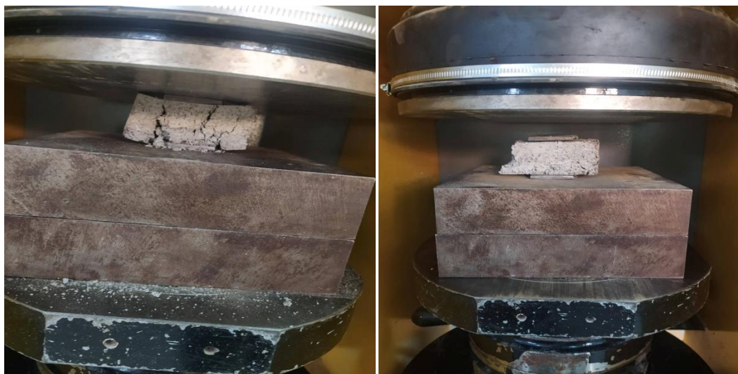
Figure 59 représente avant et après mode de rupture à essai de compression.
