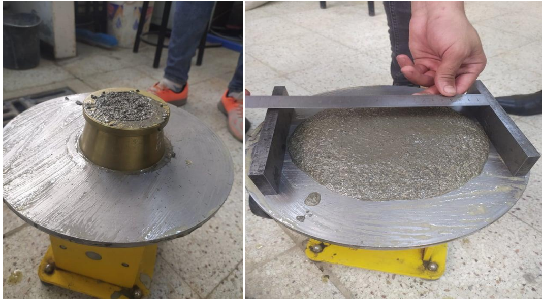
Figure 45 Remplissage du cône Etallement (MGDPCB)
