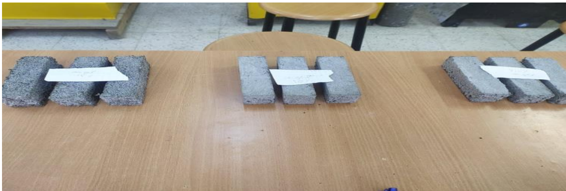
Figure 44 démoulage et Conservation des éprouvettes
