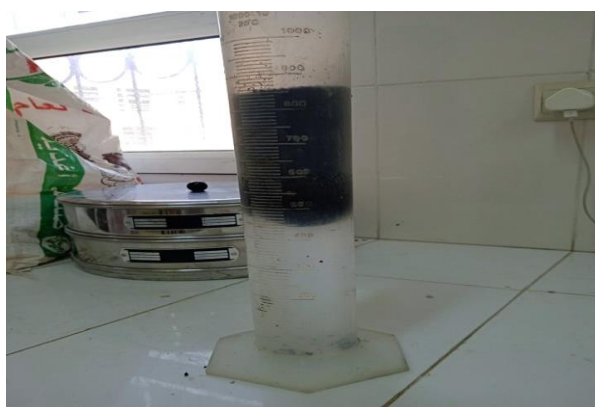
Figure 28 : détermination de la masse volumique absolue des granulats pneumatiques
