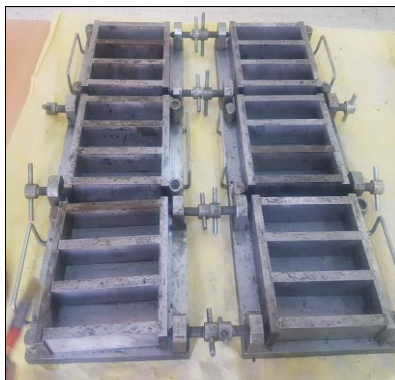
Figure 25 moules prismatiques de dimensions (4x4x16 cm 3 )
