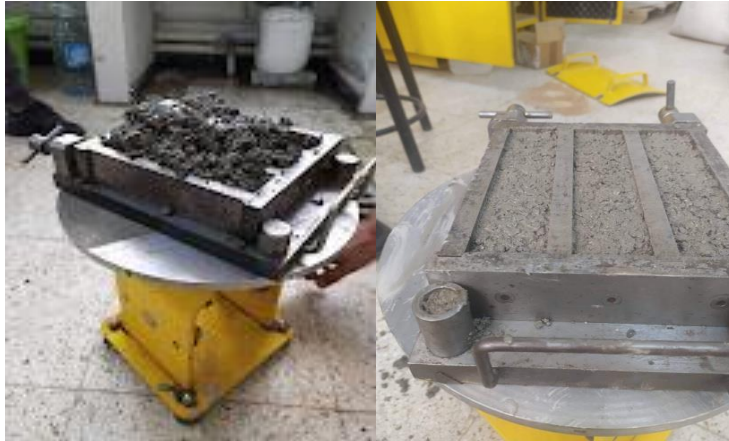
Figure 36 Vibration à la table de secousse et coulage des éprouvettes (4x4x16 cm 3 ) à base de (MGDP).
