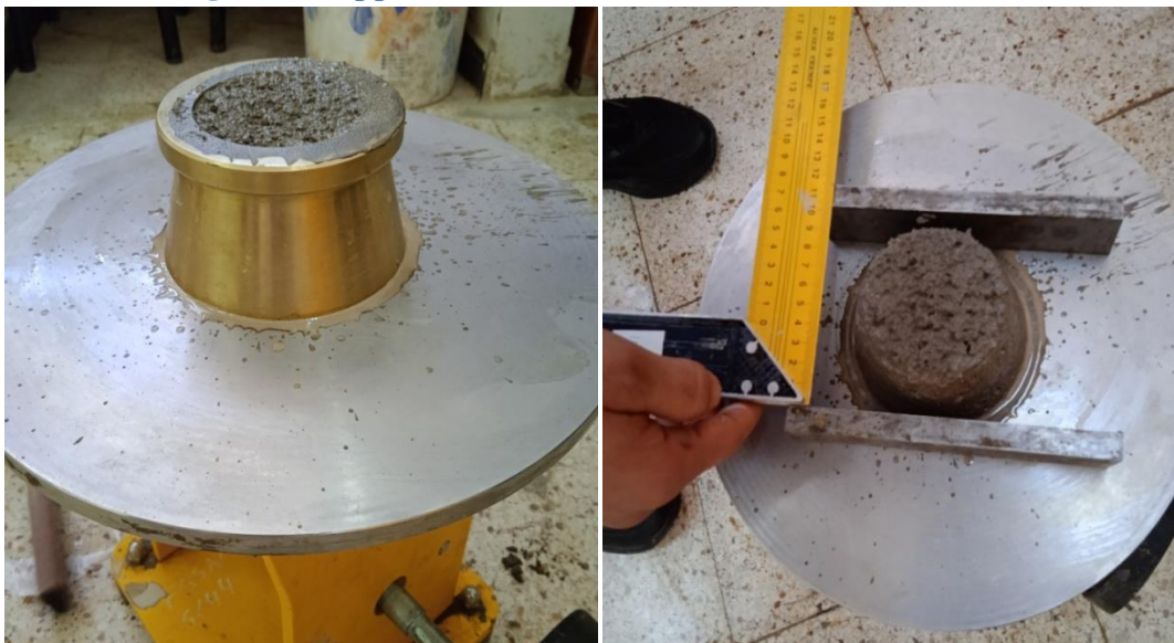
Figure 34 Mesure de l'étalement pour les mortiers.
