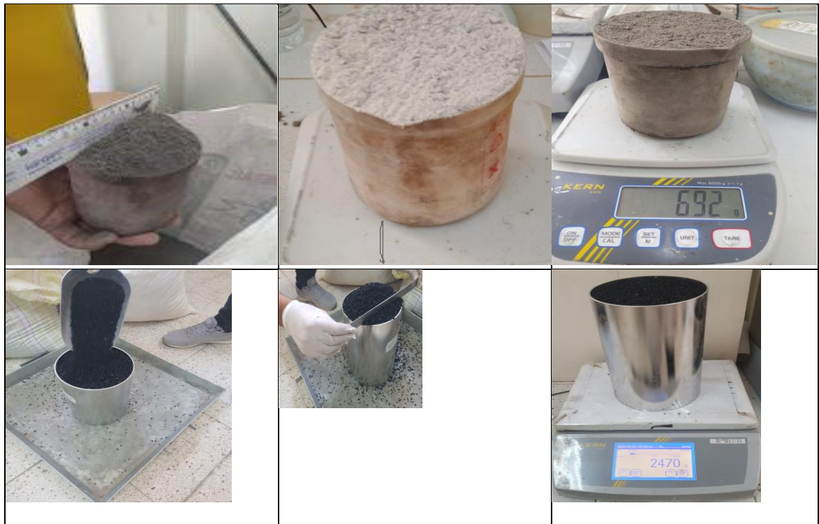
Figure Figure 27: Etapes de détermination de la masse volumique apparente
