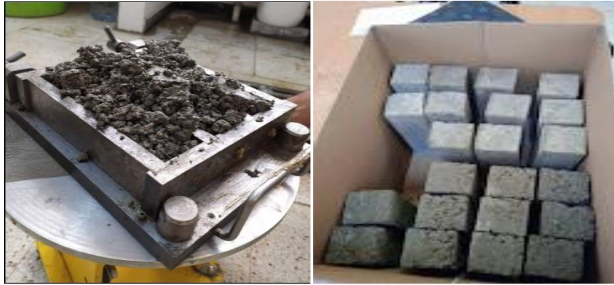
Figure 38 Vibration à la table de secousse et Démoulage des éprouvettes
