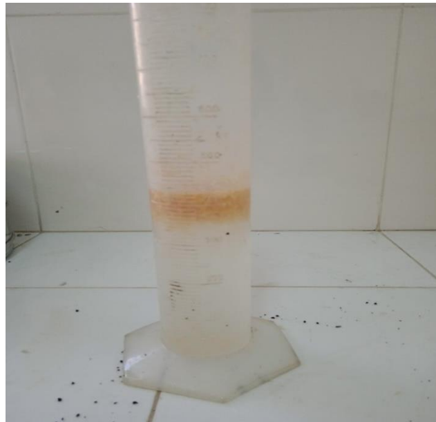
Figure 40 détermination de la masse volumique absolue de cuire de bois
