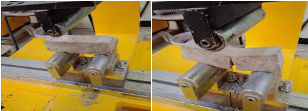
Figure 47 : essai de flexion et mode de rupture.
