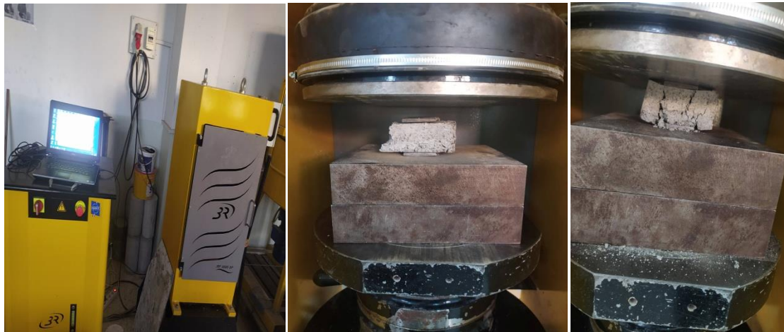
Figure 55 machine de compression et essais de compression et mode de rupture
