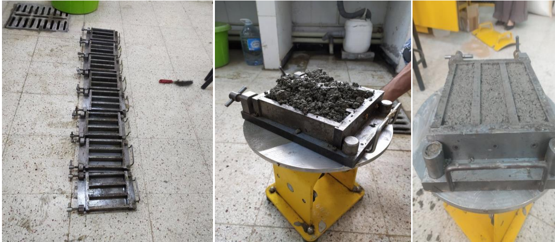
Figure 42 représente graissage des moules. Figure 43 remplissage et le vibrage des moules
