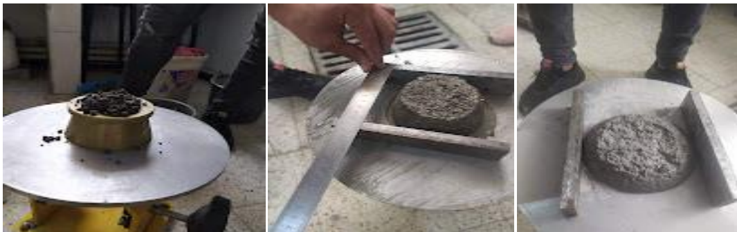
Figure 37 essai d'étalement de mortier argile.
