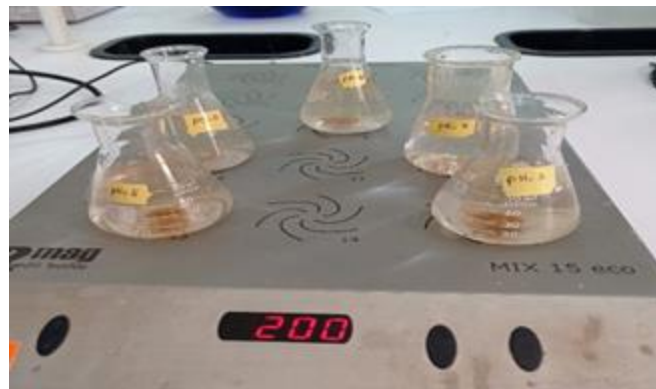
Figure 15 : Expérience de détermination du \text{pH}_{\text{pzc}} .
