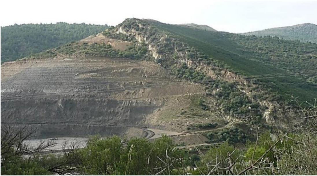
Figure II.2. Vue du gisement du Nord vers le Sud montrant l'ensemble tuf reposant sur l'argile, sous forme de monoclinale d'inclinaison générale vers le Nord-Ouest.
