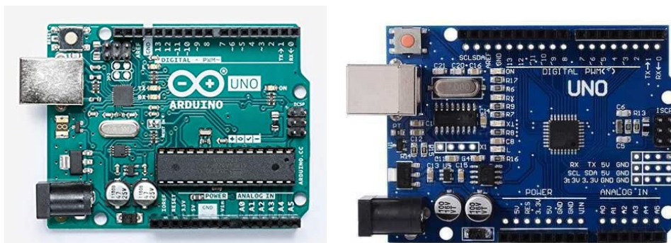
(a) ArduinoUno avec micro-contrôleur (b) ArduinoUno avec micro-contrôleur SMD ATmega 328
