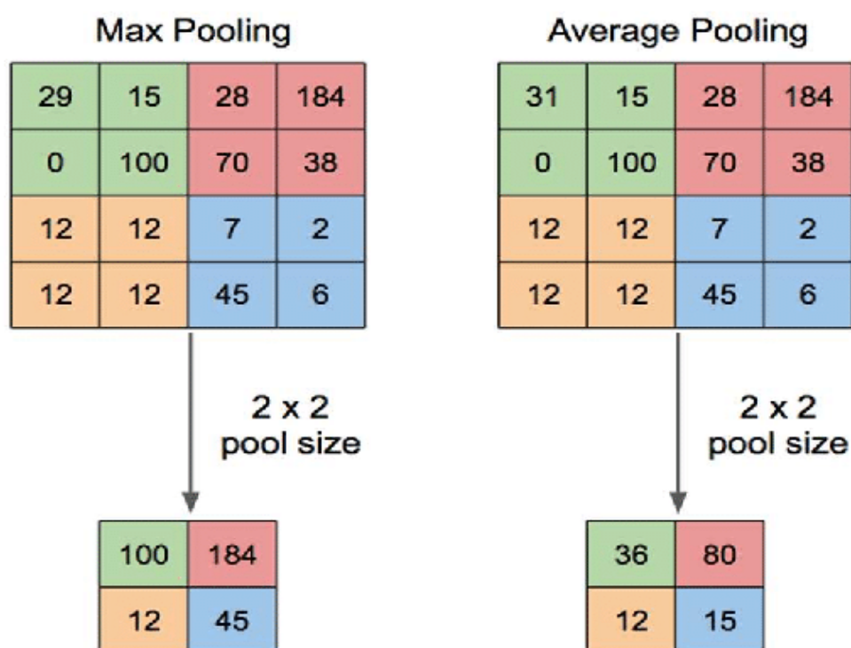
FIGURE 2.8 – Concept du pooling au niveau de la couche Pooling.
