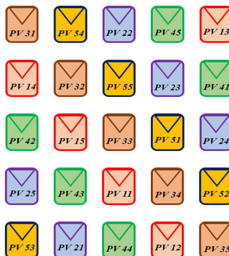
FIGURE 4.5 – Disposition en DS du générateur PV pour une matrice (5x5)
