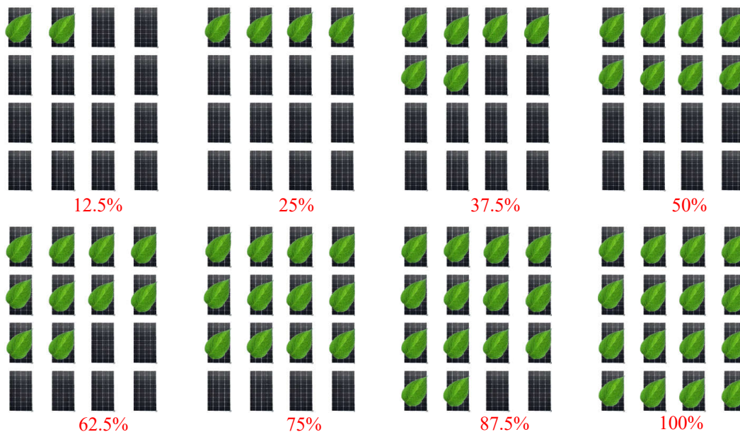
FIGURE 3.9 – Les cas ombrage progressif en parallèle
