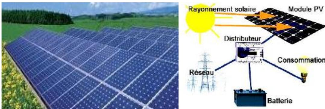
Figure I.10: Système Photovoltaïque. [11][12]
