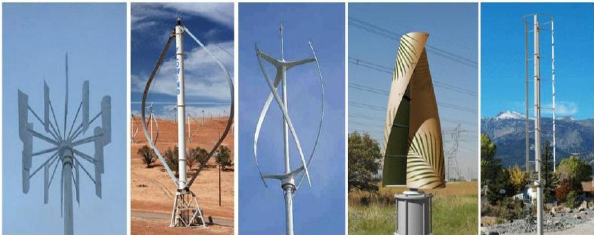
Figure I.13: Eoliennes à axes vertical. [15]
