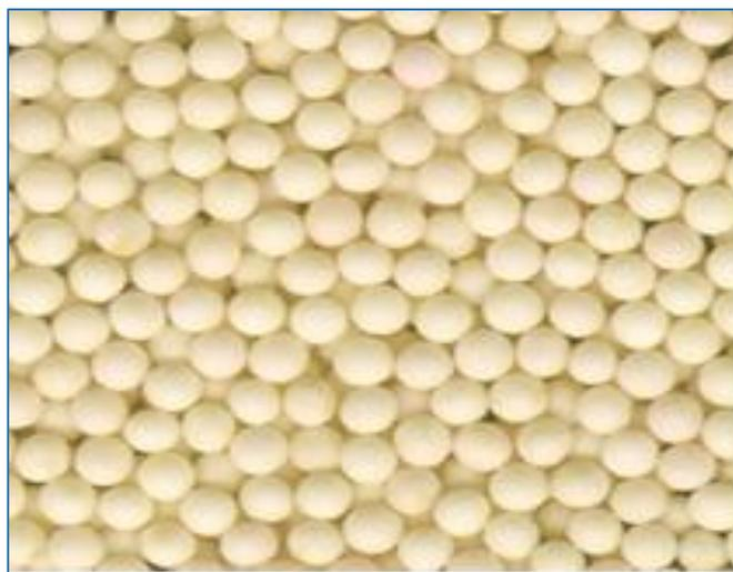
**Figure II-5 :** Catalyseur CR 401 vierge [28].
