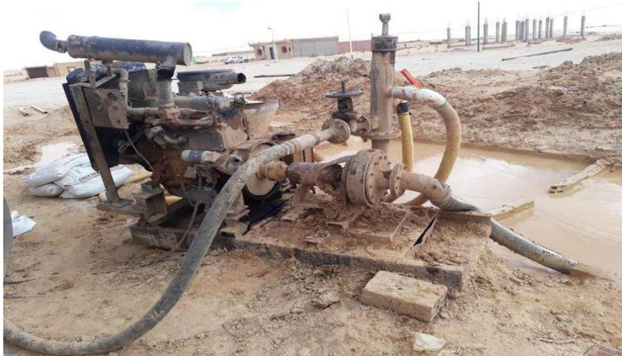
**Figure 12: La pompe a boue utilisée dans la réalisation de forage**
