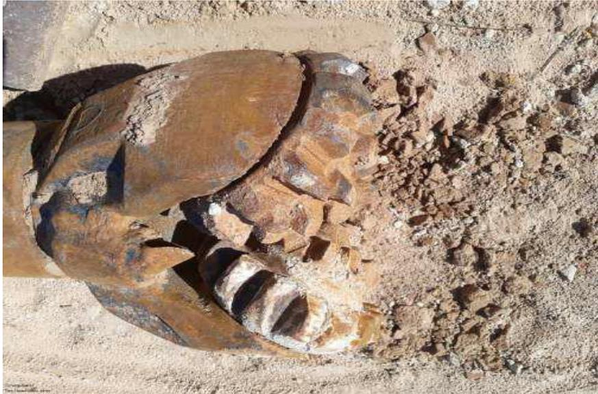
**Figure 11: L'outil de forage ( le trépan )**
