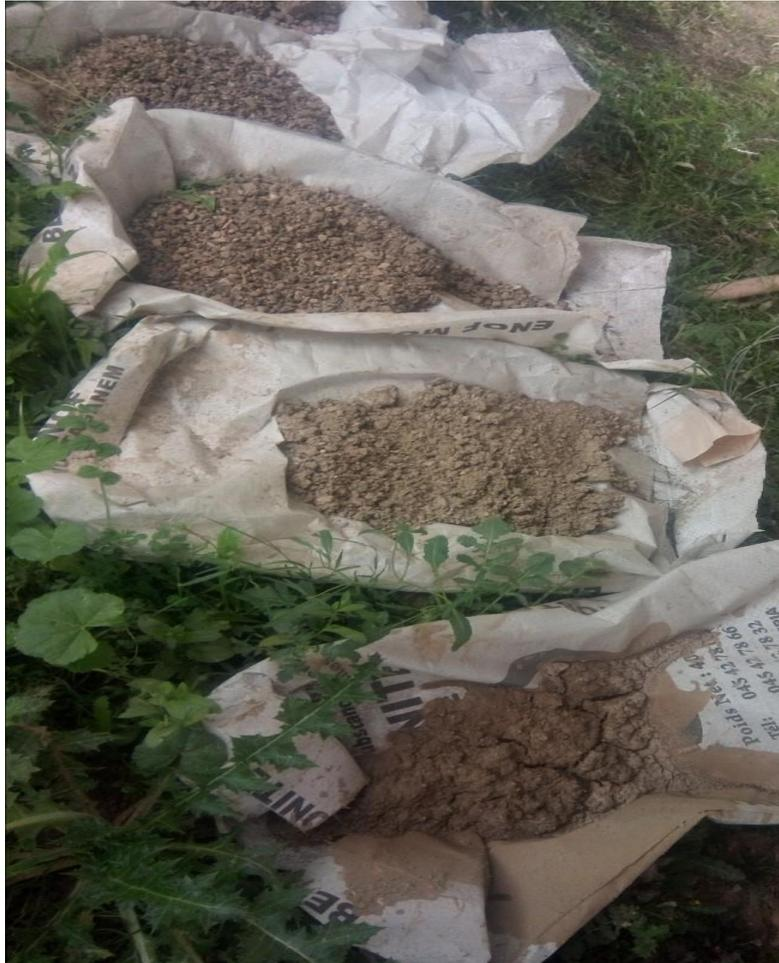
**Figure 23: Cuttings (débris échantillons) de forage BirOuledKhelifa**
