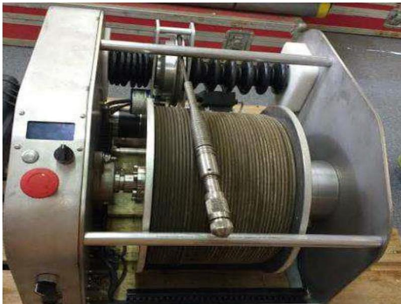
Figure 14: Le treuil de forage
