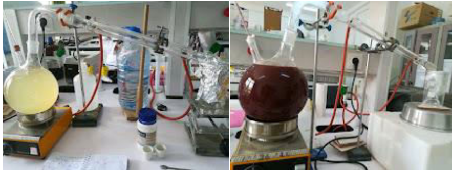
Figure III.6. : Montage de Distillation du mélange
