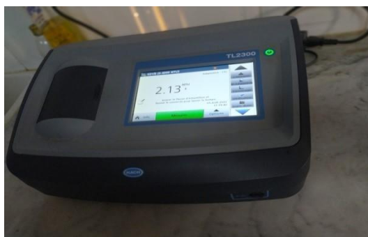
Figure II.04 : Appareil de mesure de la turbidité.
