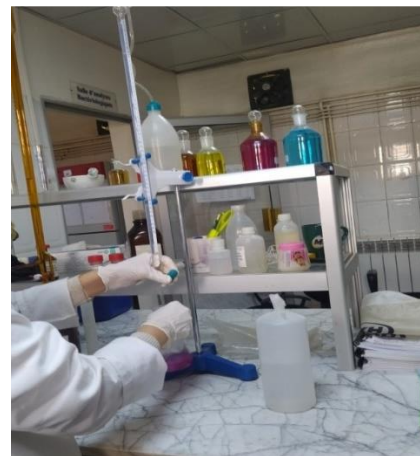
Figure II. 9 : Titrage de Calcium
