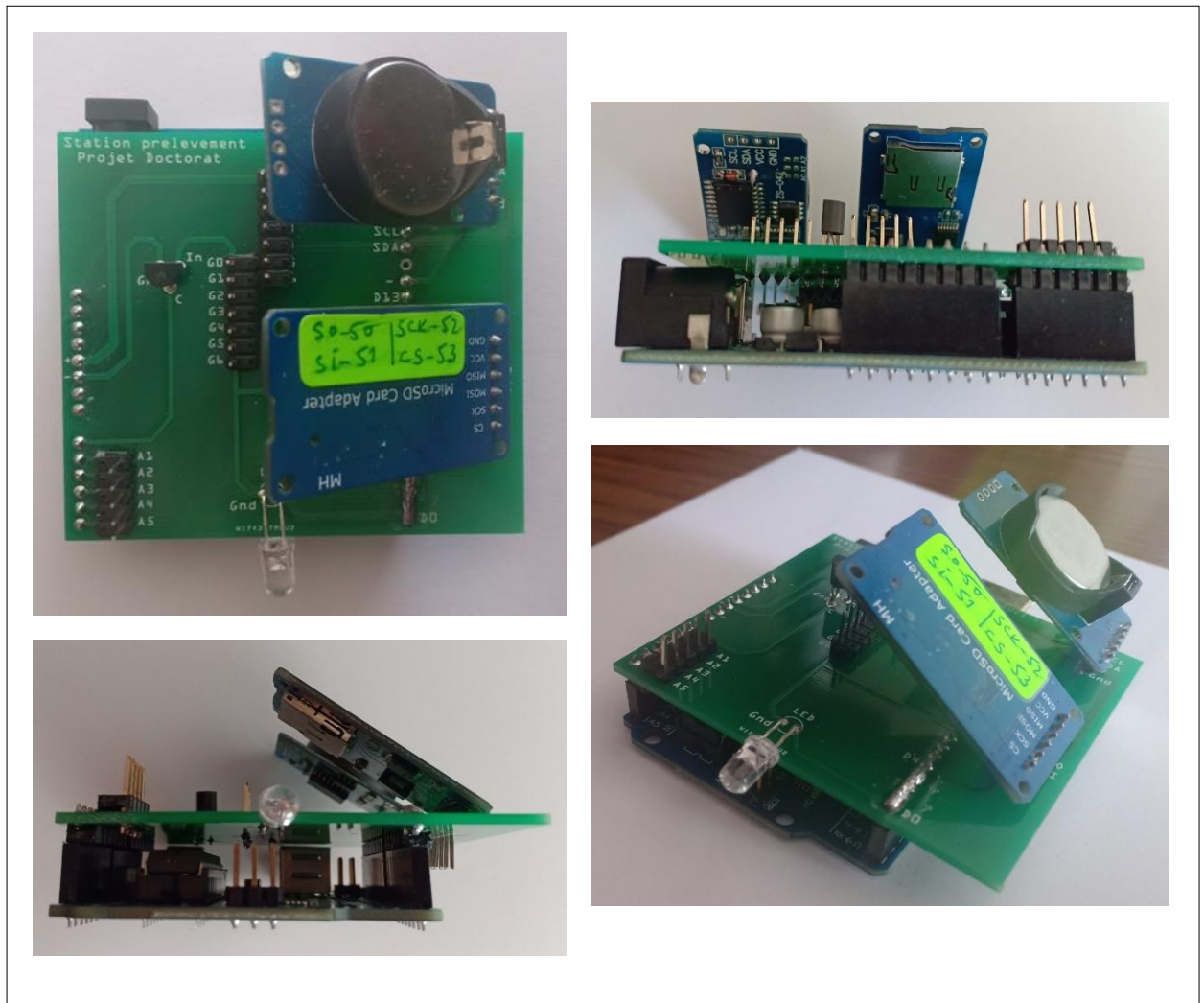
Figure IV.1: Circuit imprimé de la station montée sur la carte Arduino UNO
