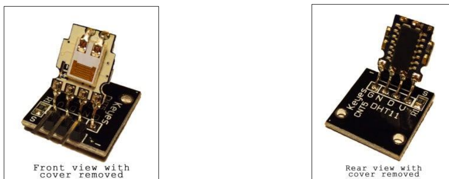
Figure III.9: Capteur DHT 11 décortiqué
