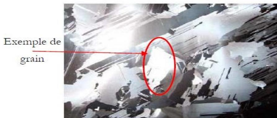
*Figure I.22 : Photo d'un substrat de Silicium multi cristallin*
