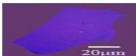
Figure I.3.3 : Image d'un graphène multicouche (épaisseur = 3 nm) exfolié sur du Si/SiO 2 .
