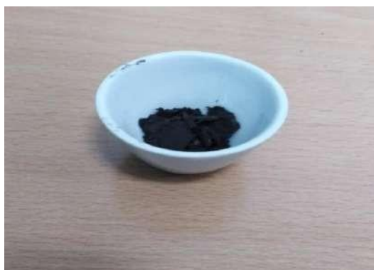
Figure IV.6. CuO supporté sur la zéolite après calcination.
